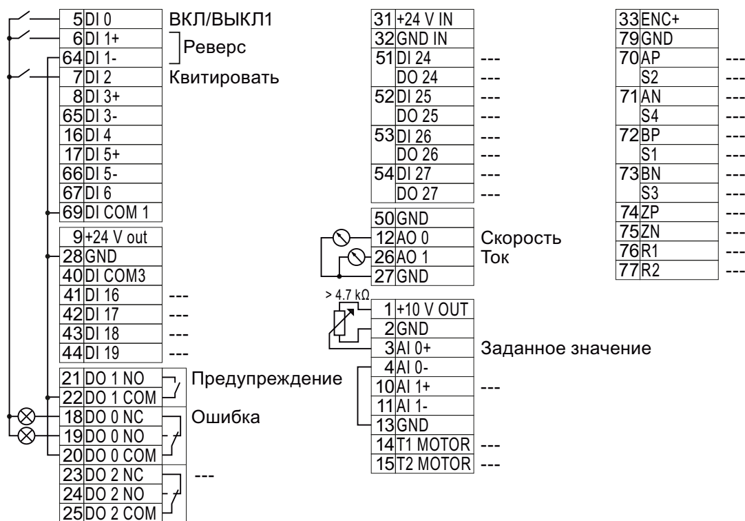
Изображени Электромонтаж при заводской установке CU250S-2 е 5-1
